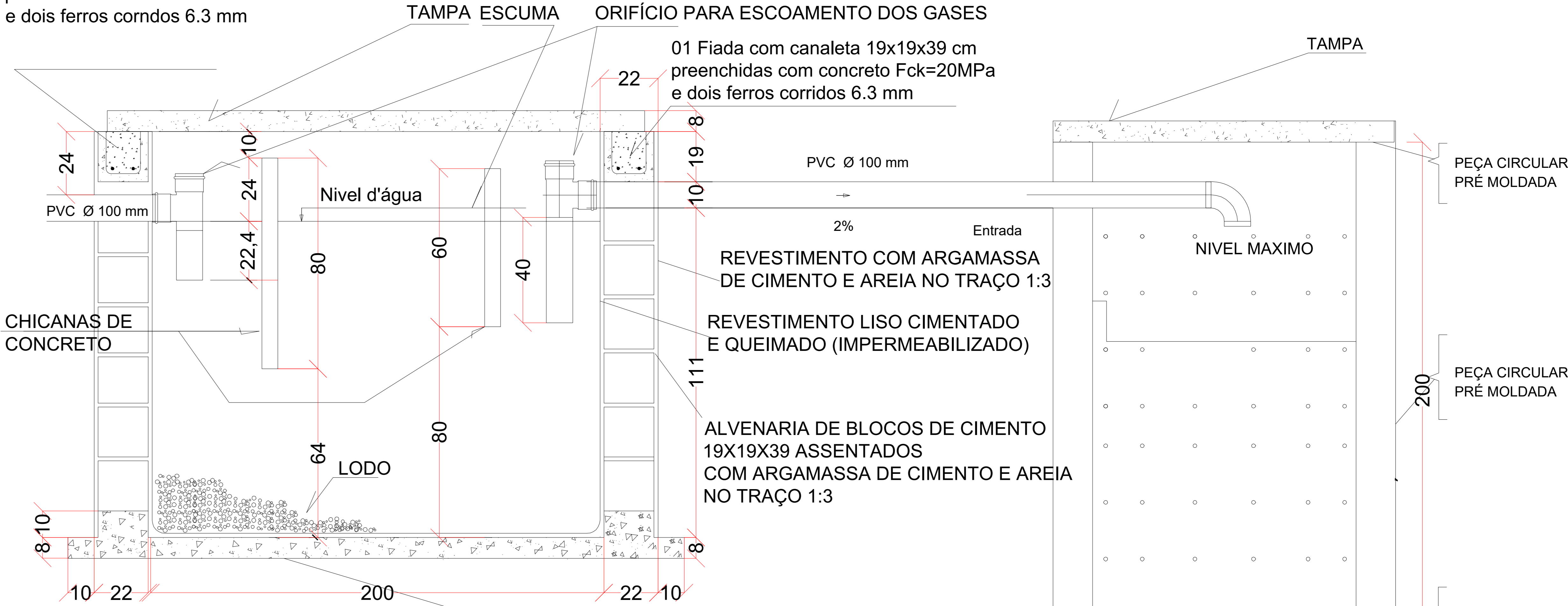
TANQUE SÉPTICO CORTE - ESC. 1:25
